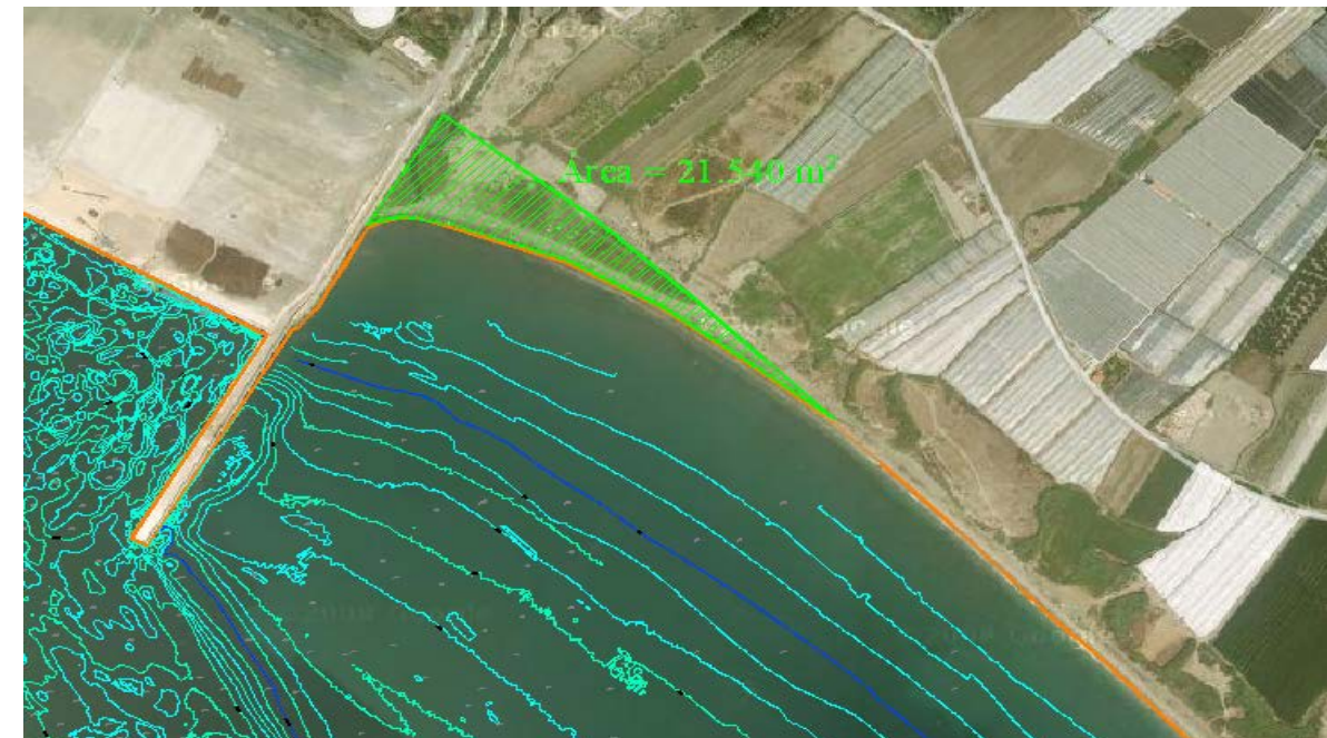
Figura 19: Estado actual en la playa de las Azucenas, con la acumulación de material junto al contradique del Puerto de Motril.
